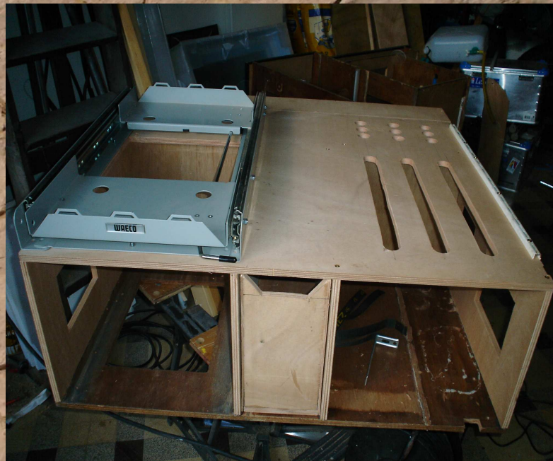
Mise en place du porte frigo WAECO ( fini les glissières qui sautent, là,c'est du costaud )
